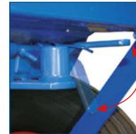
automatische Sicherung der Zugöse durch einen Federmechanismus wird die Deichsel gegen ein ungewolltes Lösen gesichert
